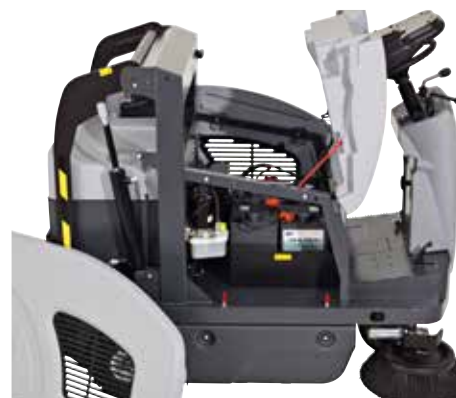
Les balais, les filtres et les panneaux se démontent sans outil pour simplifier et réduire les coûts d'entretien.
