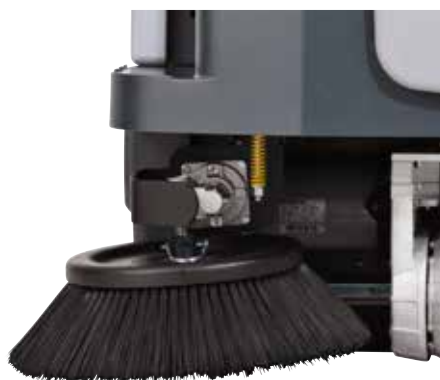
Le système Dustguard™ (disponible en option) permet le contrôle de la poussière sur les balais latéraux pour une plus grande productivité.
